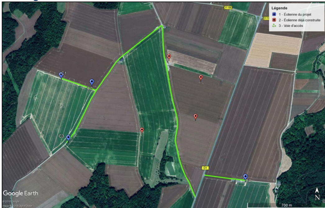
Figure 5 : Tracés des chemins d'accès aux éoliennes
